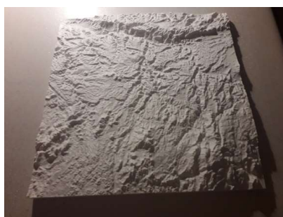
Maquette du bassin versant de la vallée de l'Arghen réalisée(45cm x 45 cm) au 1/100 000ième, exagération verticale 2
